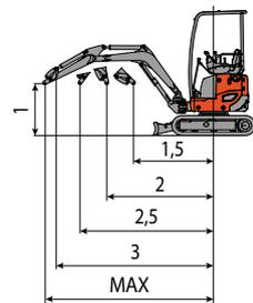
Hebekraft basierend auf ISO-Norm 10567 und überschreitet nicht mehr als 75% der Kippplast oder 87% der hydraulischen Hebe-Kapazität der Maschine.
